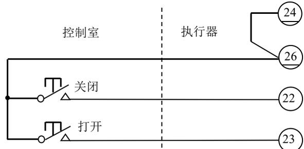
图 6-3 远方无源保持式打开/关闭控制，行程可逆，但不能停在中途位置
