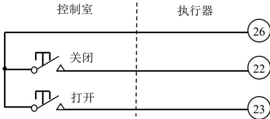
图 6-2 远方无源点动式打开/关闭控制，执行器可以停在中途任意位置
