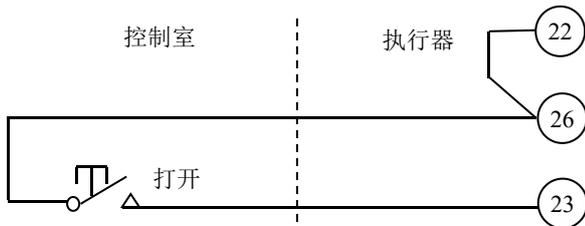
图 6-11 远方无源两线控制，有信号开，无信号关
